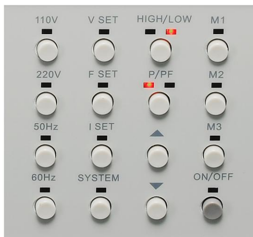
图 4.1 操作面板按键布局图
